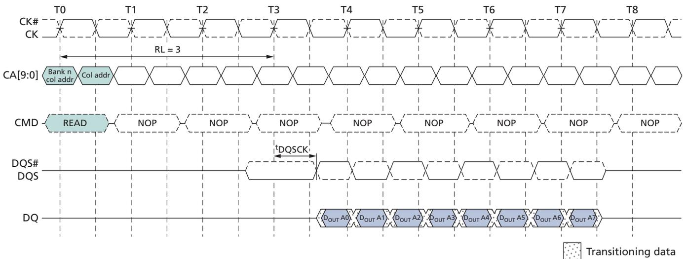
Figure 17:  $t_{DQSKDL}$  Timing
