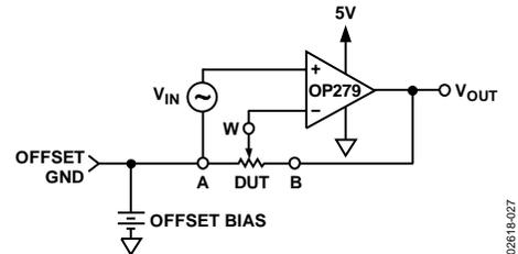
Figure 27. Noninverting Gain
