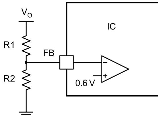
Figure 24. Voltage-Divider Circuit
