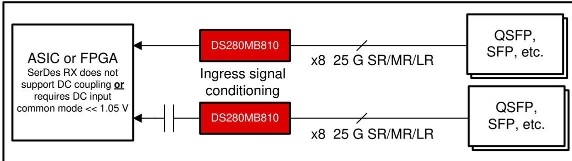
**Figure 9-8. DS280MB810 or DS280DF810 recommended for front-port Ingress**
