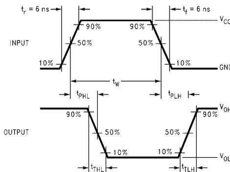
**FIGURE 3. AC Waveforms**
