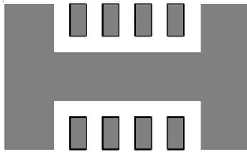
(d) Copper Area = 50mm<sup>2</sup>,  $\theta_{JA} = 51^{\circ}\text{C/W}$
