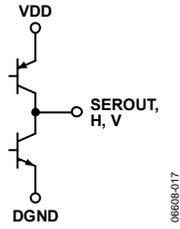
Figure 18. SEROUT, H, V Logic Outputs
