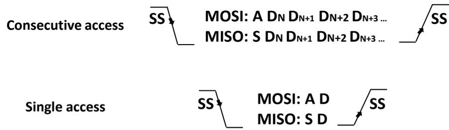
KEY: A: Address byte, D: Data byte, S: Status byte
