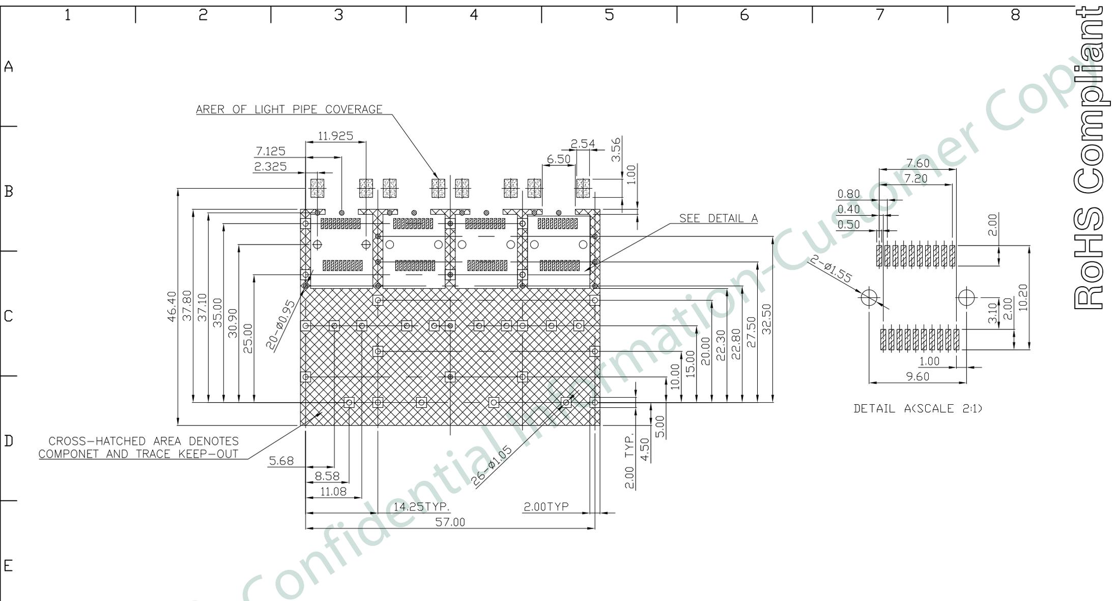
RECOMMENDED PCB LAYOUT (COMPONENT SIDE)
