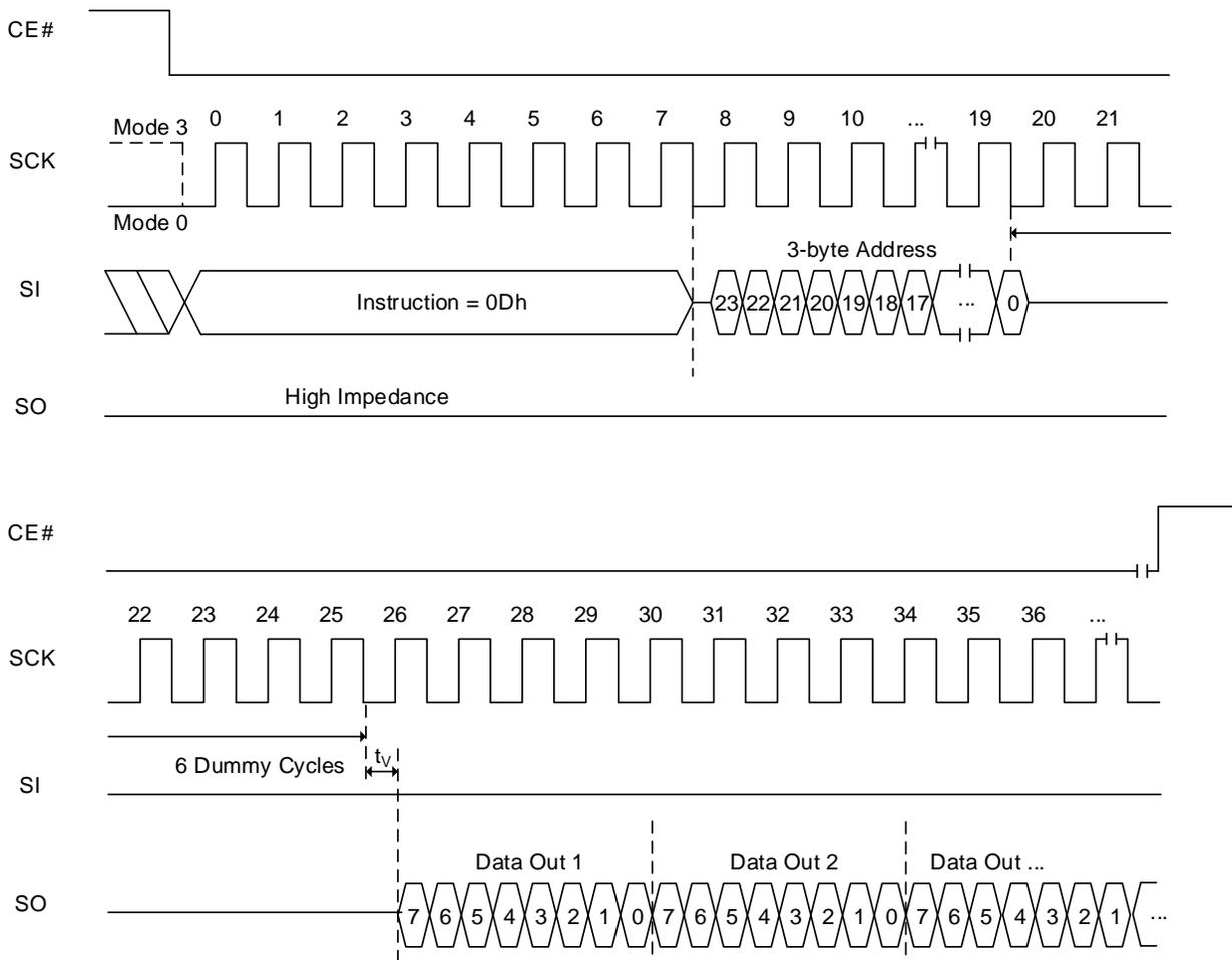
**FAST READ DTR MODE OPERATION IN QPI MODE (FRDTR, 0Dh)**
