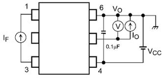
$$*V_{OH} = V_{CC} - V_O$$
