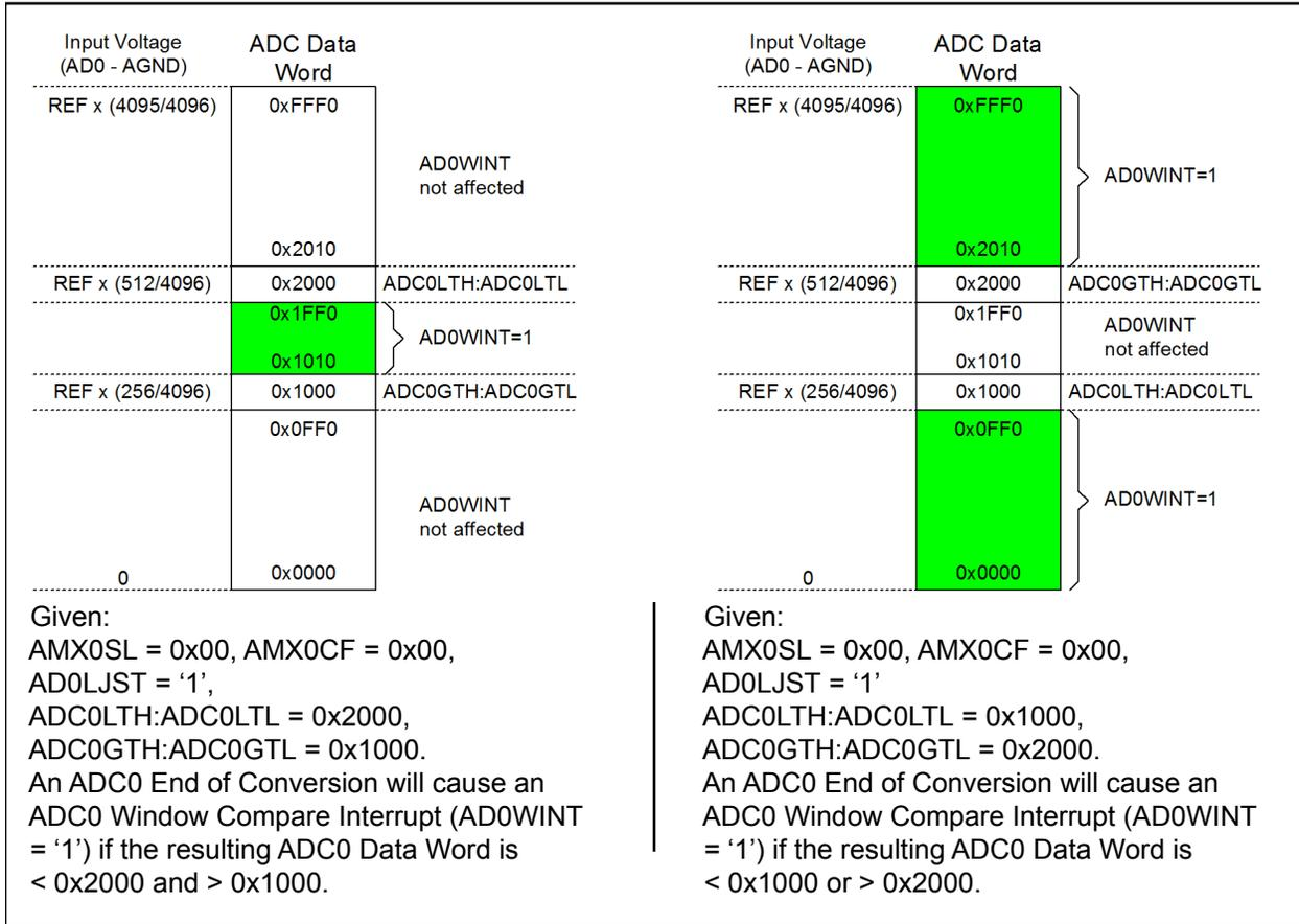
**Figure 5.10. 12-Bit ADC0 Window Interrupt Example:
