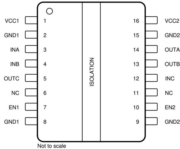
**Figure 5-1. ISO6731-Q1 DW Package 16-Pin SOIC-WB Top View**
