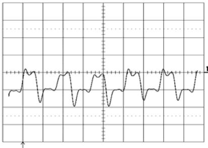
Output voltage ripple (20mV/div.) at:
