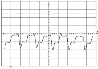
Output voltage ripple (20mV/div.) at:
