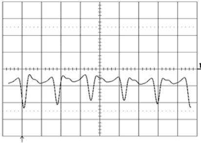
Output voltage ripple (20mV/div.) at:
