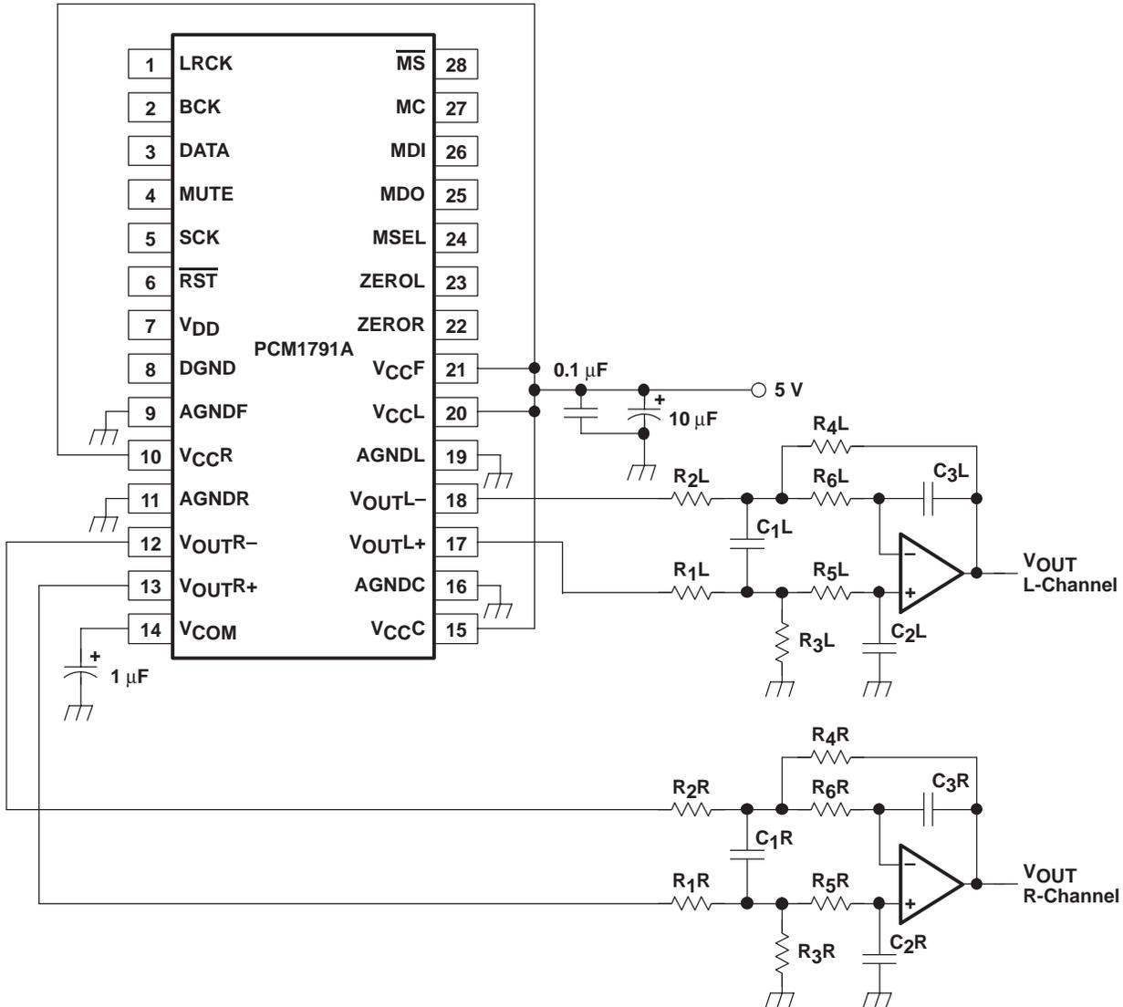
NOTE: Example R and C values for  $f_C = 77$  kHz –  $R_1, R_2$ : 1.8 k $\Omega$ ,  $R_3, R_4$ : 3.3 k $\Omega$ ,  $R_5, R_6$ : 680  $\Omega$ ,  $C_1$ : 1800 pF,  $C_2, C_3$ : 560 pF.
