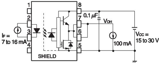
Fig. 4 V<sub>OL</sub> Test Circuit
