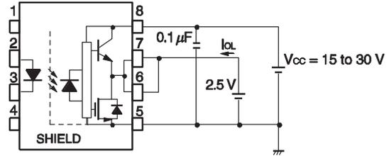
Fig. 3 V<sub>OH</sub> Test Circuit
