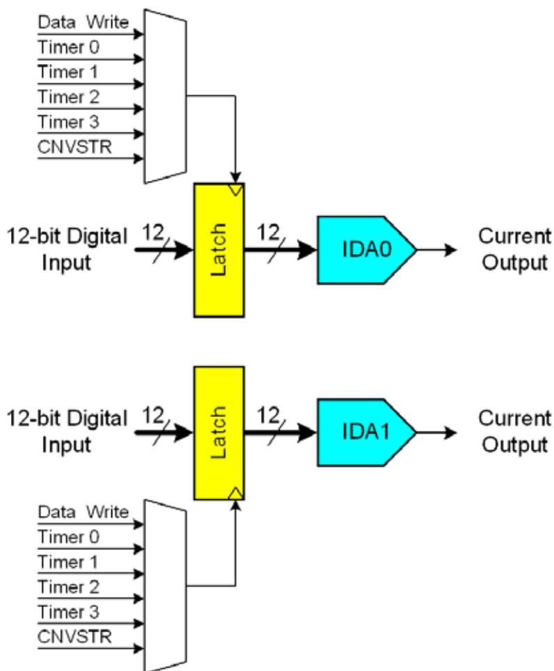
**Figure 1.8. IDAC Block Diagram**
