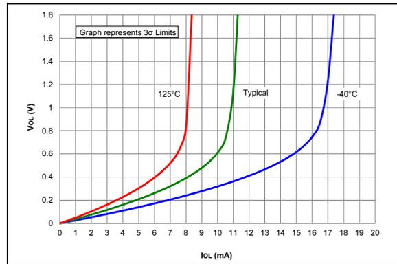
**FIGURE 36-40:**  $V_{OL}$  vs.  $I_{OL}$
