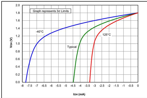
**FIGURE 36-39:**  $V_{OH}$  vs.  $I_{OH}$
