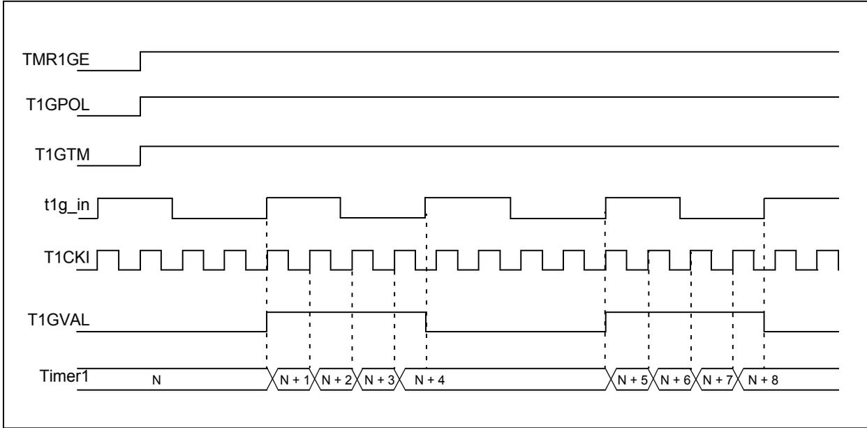
**FIGURE 27-6: TIMER1 GATE SINGLE-PULSE MODE**
