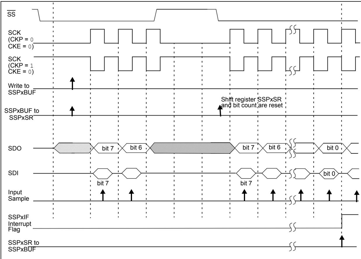
**FIGURE 30-9: SPI MODE WAVEFORM (SLAVE MODE WITH CKE = 0)**
