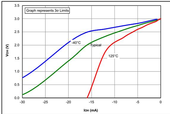
**FIGURE 36-37:**  $V_{OH}$  vs.  $I_{OH}$
